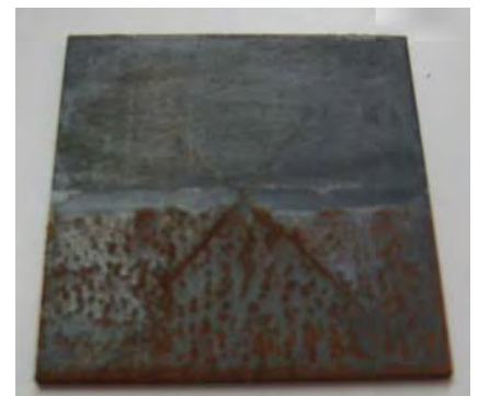
Δοκιμές αλατονέφωσης χαλύβδινων πλακών επί 250 ώρες.
