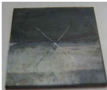
Δοκιμές αλατονέφωσης χαλύβδινων πλακών επί 250 ώρες.
